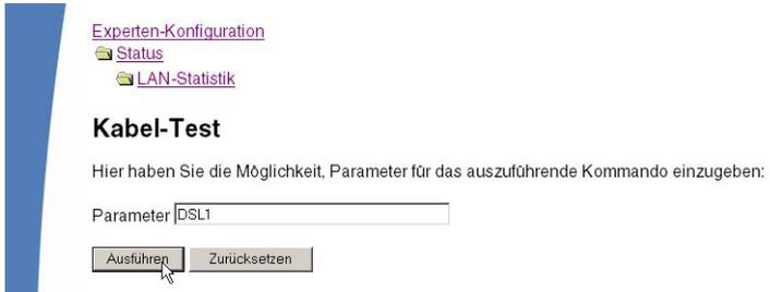
Wechseln Sie anschließend in den Menüpunkt **Expertenkonfiguration** ► **Status** ► **LAN-Statistik** ► **Kabel-Test-Ergebnisse**. In der Liste sehen Sie die Ergebnisse, die der Kabel-Test für die einzelnen Interfaces ergeben hat.
