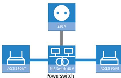
Die PoE-Versorgung funktioniert nur in solchen Netzwerksegmenten, in denen ausschließlich PoE-fähige Geräte betrieben werden. Der Schutz von Netzwerkgeräten ohne PoE-Unterstützung wird über einen intelligenten Mechanismus gewährleistet, der vor Einschalten der PoE-Stromversorgung das Netzwerksegment auf Geräte ohne PoE-Unterstützung untersucht. Die Spannung wird nur dann auf das LAN geschaltet, wenn sich dort ausschließlich Geräte mit PoE-Unterstützung befinden.
