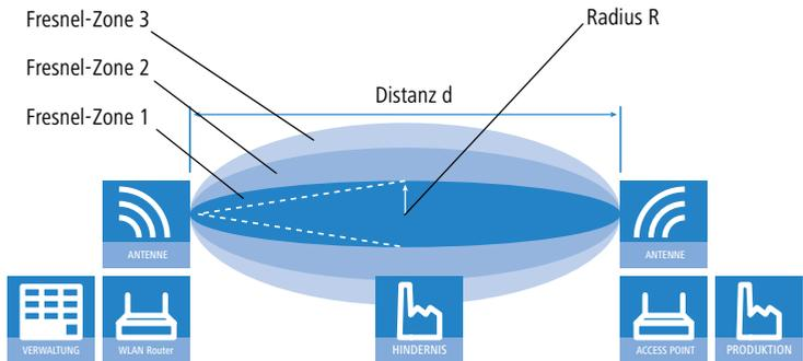
Um die von der Antenne abgestrahlte Leistung möglichst vollständig auf die empfangende Antenne abzubilden, muss die Fresnel-Zone 1 frei bleiben. Jedes störende Element, das in diese Zone hineinragt, beeinträchtigt die effektiv übertragene Leistung deutlich. Dabei schirmt das Objekt nicht nur einen Teil der Fresnel-Zone ab, sondern führt durch Reflexionen zusätzlich zu einer deutlichen Reduzierung der empfangenen Strahlung.
