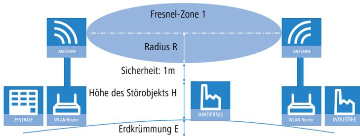
$$M = R + 1\text{m} + H + E \text{ (Erdkrümmung)}$$
