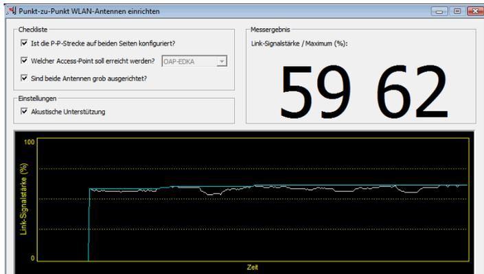
Bewegen Sie zunächst nur eine der beiden Antennen, bis Sie den Maximalwert erreicht haben. Stellen Sie dann die erste Antenne fest und bewegen Sie auch die zweite Antenne in die Position, bei der Sie die höchste Signalqualität erzielen.
