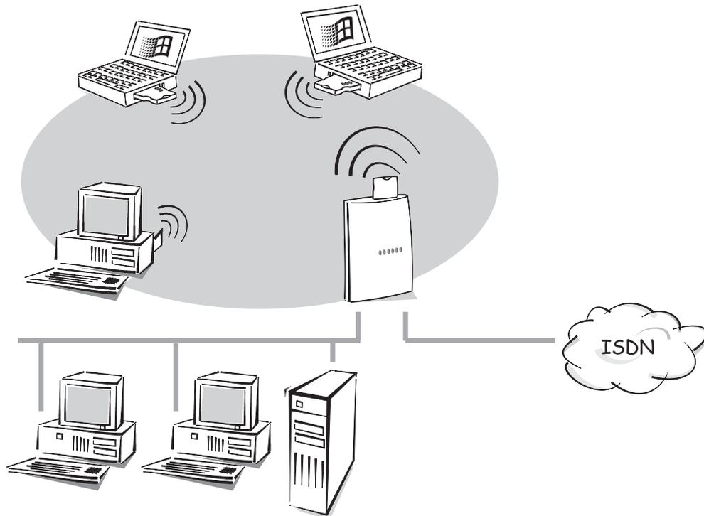
Zusammen mit dem Funktionsumfang eines IP-Routers sind damit weitere Anwendungen wie der Zugriff auf das Internet für alle Rechner im LAN und WLAN möglich.
