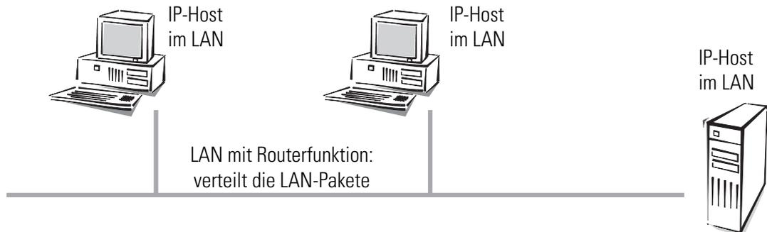
Für einen Router im LAN erscheint ein Host im eigenen LAN, als wenn er hinter sich einem weiteren Router befindet. Der Router steht also vor einer einfachen Aufgabe: Da er für den Betrieb im IP-Netz nur die IP-Adressen
