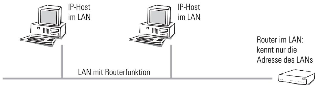
Der Host steht dagegen vor einer schwierigeren Aufgabe als der Router. Bei einer Schnittstelle mit Punkt-zu-Punkt-Kabel weiß ein Host, daß alle Pakete, die er über die Schnittstelle verschickt, automatisch z.B. bei seinem Router ankommen. Bei der Punkt-zu-Mehrpunkt-Verbindungen zum LAN muß er nun aber zwei Fälle unterscheiden.
