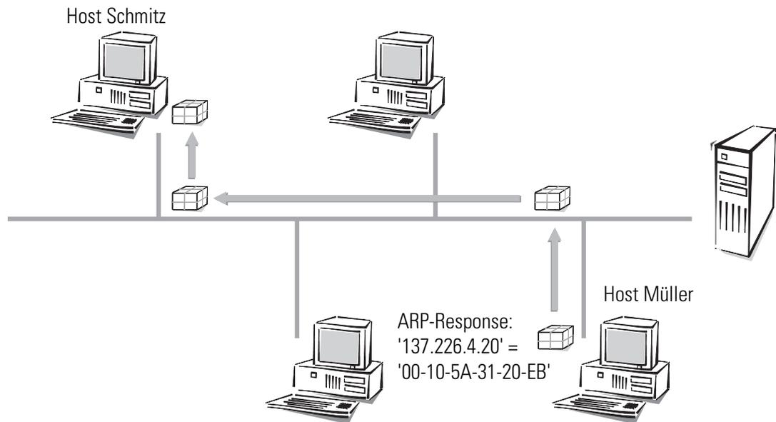
Anschließend kann er sich endlich seiner ursprünglichen Aufgabe zuwenden, das IP-Paket an Host Müller zu verschicken. Er findet jetzt in der ARP-Tabelle den Eintrag „IP-Adresse 137.226.4.20 entspricht MAC-Adresse '00-10-5A-31-20-EB'“ und sagt seiner LAN-Schnittstelle: „Verschicke dieses IP-Paket an den Rechner mit der MAC-Adresse '00-10-5A-31-20-EB'“.
