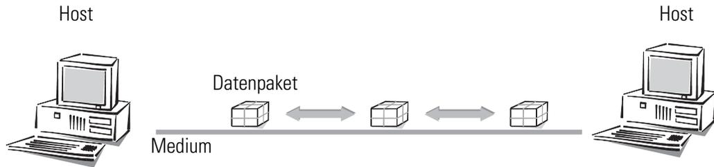
Auch bei einem Zugriff auf das Internet handelt es sich um eine Punkt-zu-Punkt-Verbindung. Die Datenpakete werden zwar vom Host beim Internetbenutzer über mehrere Router zum Host (Server) beim Internet-Provider gesendet, jedes Datenpaket hat jedoch ein ganz bestimmtes Ziel. Die Router geben die Datenpakete auch nur an genau einen Empfänger weiter. Daher bezeichnen wir auch diese Verbindung als eindeutig.
