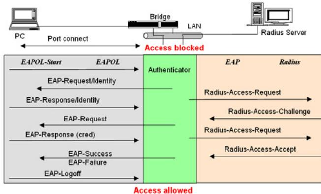
Die Abbildung zeigt den Ablauf einer 802.1x Authentifizierung. Die Login-Schritte basieren auf 802.1x Port-Zugangs-Kontrollmanagement. Auf der linken Seite kommt das EAPOL-, auf der rechten das EAP-Protokoll zum Einsatz.
