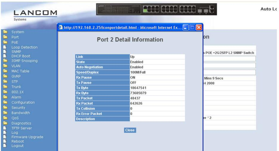
Das Detailfenster zeigt die grundlegenden Informationen zum Status, zum Traffic und der Bandbreite für den jeweiligen Ein- und Ausgang eines gewählten Ports.
