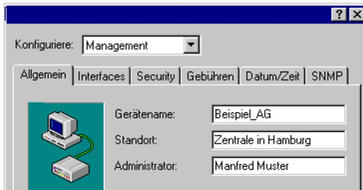
Bei Konfigurationen mit anderen Hilfsmitteln stellen Sie den Namen des Gerätes direkt im Menü 'Setup' ein:
