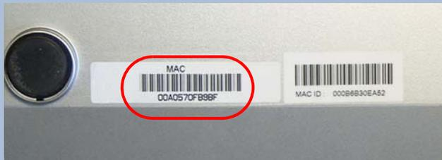
Für ein Gerät mit der LAN-MAC-Adresse „00A0570FB9BF“ lautet der Standard-WEP-Schlüssel also „L00A0570FB9BF“. Dieser Schlüssel wird in den 'Einzel-WEP-Einstellungen' des Gerätes für jedes logische WLAN-Netzwerk als 'Schlüssel 1' eingetragen.
