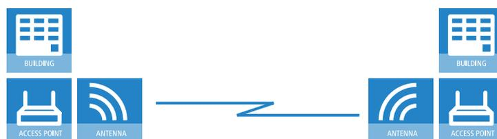
Mit einer Punkt-zu-Punkt-Verbindung kann aber z. B. auch in schwierigem Gelände (z. B. in den Bergen oder auf einer Insel) ein Internetzugang an Orten bereitgestellt werden, an denen eine Verkabelung zu aufwendig wäre. Bei direkter Sichtbeziehungen zwischen den beiden APs können mit diesen Funkstrecken Distanzen von mehreren Kilometern überbrückt werden.
