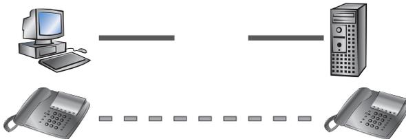
Der FTP-Transfer setzt recht große Datenpakete von 1500 Byte ein, während die Voice-over-IP-Verbindung Pakete von z.B. netto 24 Byte in relativ kurzen Takten verschickt. Wenn sich in dem Moment, in dem ein VoIP-Paket übertragen werden soll, z.B. schon FTP-Pakete in der Sendequeue des LANCOM befinden, kann das VoIP-Paket erst dann verschickt werden, wenn die Leitung wieder frei ist. Je nach Übertragungsrate der Verbindung kann das zu einer merklichen Verzögerung der Sprachübertragung führen.
