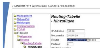
Für das „VPN-Gateway-2“ sind die folgenden Einträge erforderlich, damit die entfernten Netzabschnitte erreicht werden:
