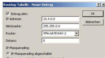
Für das „VPN-Gateway-1“ sind die folgenden Einträge erforderlich, damit die entfernten Netzabschnitte erreicht werden:
