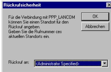
Der Rückruf an einen Windows-Rechner erfolgt ca. 15 Sekunden, nachdem die erste Verbindung abgebaut wurde. Diese Zeit kann nicht verkürzt werden, da sie von Windows vorgegeben wird.
