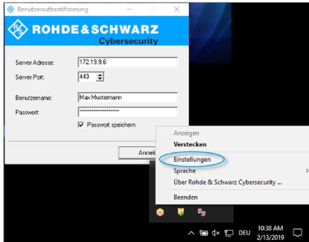
Abbildung 32: LANCOM R&S<sup>®</sup> Unified Firewall Benutzerauthentifizierungs-Client-Einstellungen
