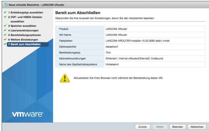
9. Nachdem der Bereitstellungsassistent abgeschlossen ist, ist der vRouter betriebsbereit. Ist in dem Netzwerk, welchem Ethernet1 zugeordnet ist, ein DHCP-Server aktiv oder wurde ihm im Rahmen der Konfiguration bereits eine IP-Adresse zugewiesen, kann der vRouter über dieses Netz erreicht und konfiguriert werden.
