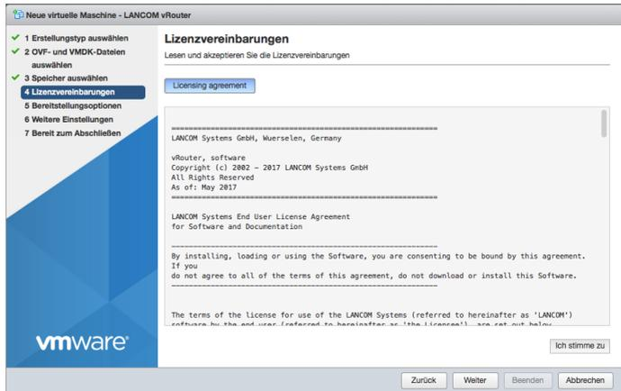
6. Weisen Sie dem vRouter mindestens ein Netzwerk zu. Weitere können Sie später nach Bedarf in den Eigenschaften der virtuellen Maschine hinzufügen. Bei **Festplattenbereitstellung** wählen Sie **Thin**.
